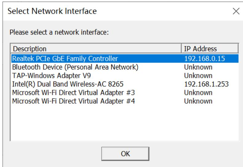
②、双击扫描出的模块，输入要设置的 IP 地址（IP 地址与本机 IP 地址要在同一网段），点击“OK”，设置完毕后，模块 BUS 红灯将不再闪烁。可以将模块 IP 地址设置拨码拨到“0X00”，即“按照上次的 DHCP 分配的 IP 地址运行”，那么每次断电上电后，模块都将按之前分配的地址运行。另外拨码也可以拨到 0x01 - 0xFE，此时前 3 位网段，按照 DHCP 分配的运行，第 4 位按照该拨码设置运行。
