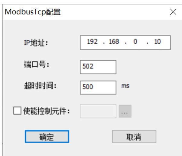
4、点击确定后，会在左侧“以太网”下方增加一个“ModbusTCP”设备
