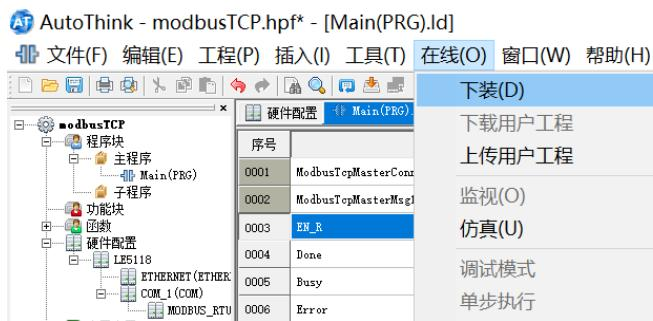
14、下装完成后，点击“在线”----“监视”，然后点击“运行”启动 PLC，此时将“ModbusTcpMasterConnect (Modbus Tcp 主站连接) ”功能块的“EN\_R”置 1，则 ModbusTCP 协议的 IO-Link 主站将正常通讯。
