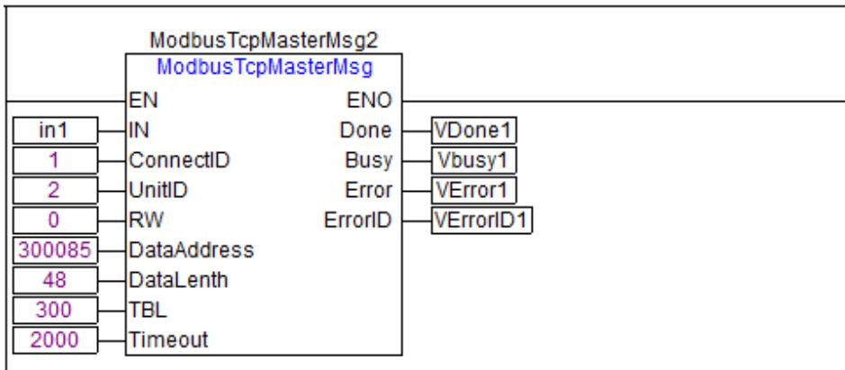
10、同理根据下图 IO-Link 主站模块输出字节所示，输出占用 Word[0]-Word[127]，一共 128 个字，也不能一次完全写入所有输出数据，所以也得分两次写入：
