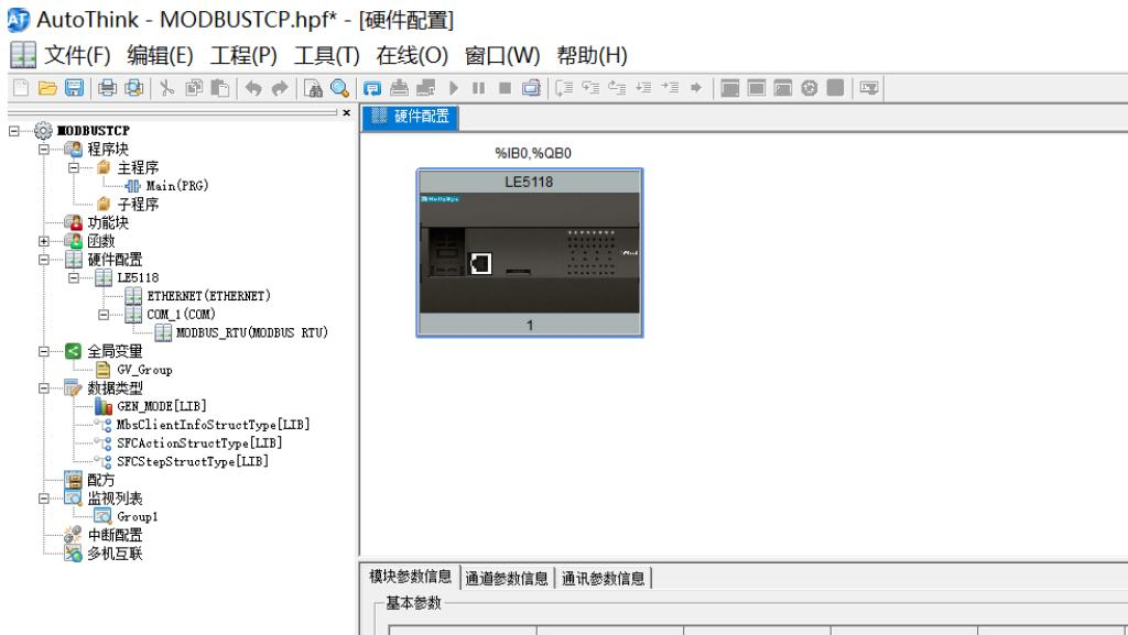
3、双击主程序“Main (PRG)”，在右侧指令库中，找到“ModbusTcpMasterConnect (ModbusTCP 主站连接)”功能块，并拖入到程序中，该功能块是将 LE5118/LE5119 模块作为 Modbus 主站与从站通讯，通过该功能块实现 Modbus TCP 通讯连接。
