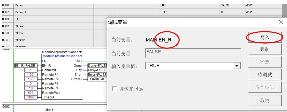
15、注意：管脚 EN\_R 需要上升沿触发连接，并且保持高电平有效。Timeout 为超时时间，超过此时间主站不再发起连接。为了不使通讯中断，需要有重连机制：当 ErrorCode 不等于 0 时，即通讯故障时，使能一个两秒脉冲信号，每隔两秒给 EN\_R 一个上升沿信号，直到通讯建立。以下示例由和利时提供。
