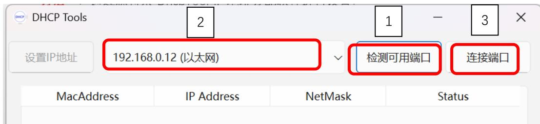
③、此时，下方将显示扫描出的森特奈 ModbusTCP 协议的 IO-LINK 主站模块，前面对应 MAC 地址
