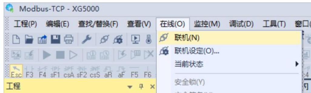
16、初次下载前，得右键 FEnet---通讯模块设定---使能 Link (HS Link, P2P) -勾选“P2P 02”，点击“确认”。
